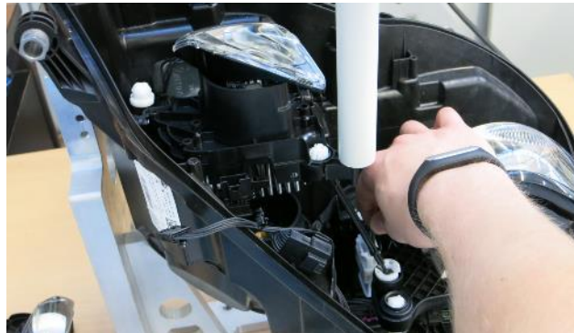
Montage eines Pkw-Scheinwerfers (Daimler E-Klasse)
